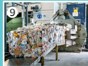
Kartons und Mischpapiere werden zu 600 Kilos schweren Ballen gepresst. Diese Ballen gehen ebenfalls in Papierfabriken. Aus Kartons und Pappe wird neues Verpackungsmaterial. Aus Mischpapieren lassen sich u. a. Papiertaschentücher herstellen.
